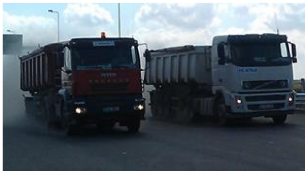
Fig. 3 Convoi de probă realizat din două camioane de 40 t în timpul încercării dinamice
