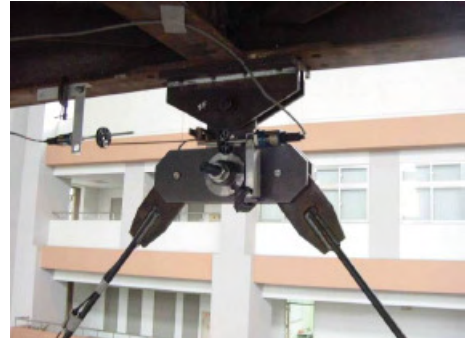
Fig. 2.2.2.2.3 Contravântuiri în V împreună cu amortizorul Damptech (10)
