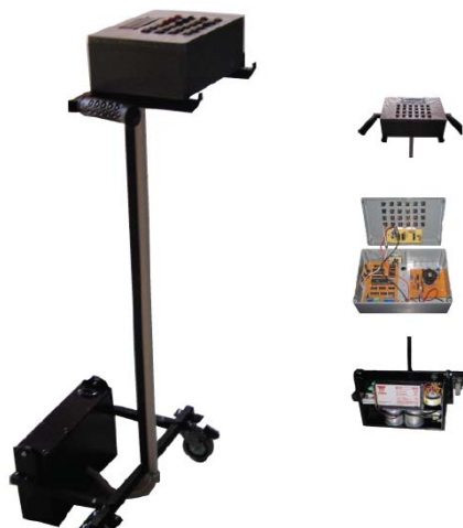
Echipment mobil de măsurare a grosimii straturilor rutiere
