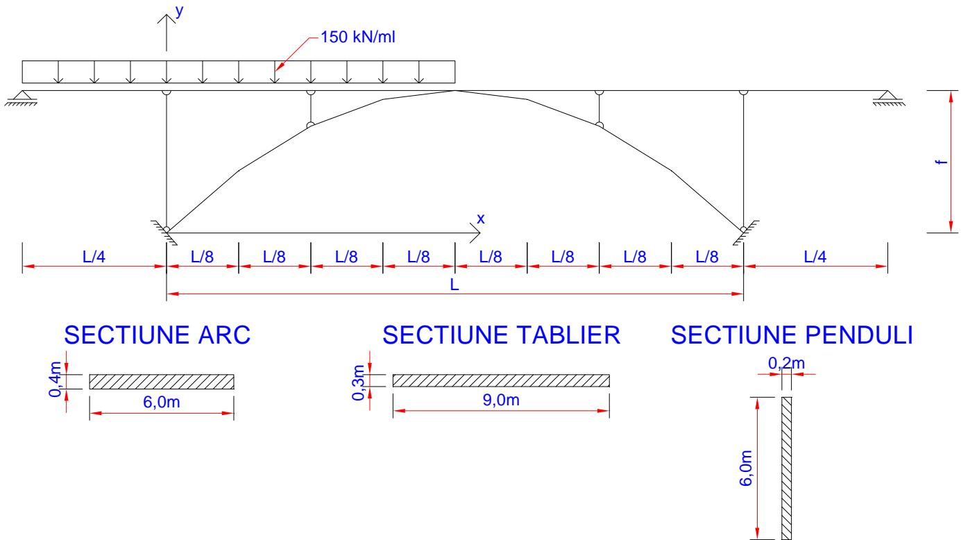
La modelarea structurii cu elemente finite se vor utiliza elemente de grinda si bare plane cu doua noduri.
