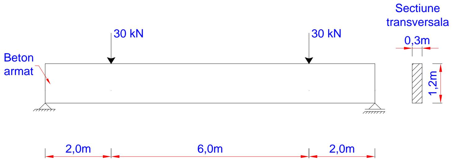
La modelarea comportarii grinzelii cu elemente finite se vor utiliza numai elemente de forma dreptunghiulara cu 4 sau 8 noduri.
