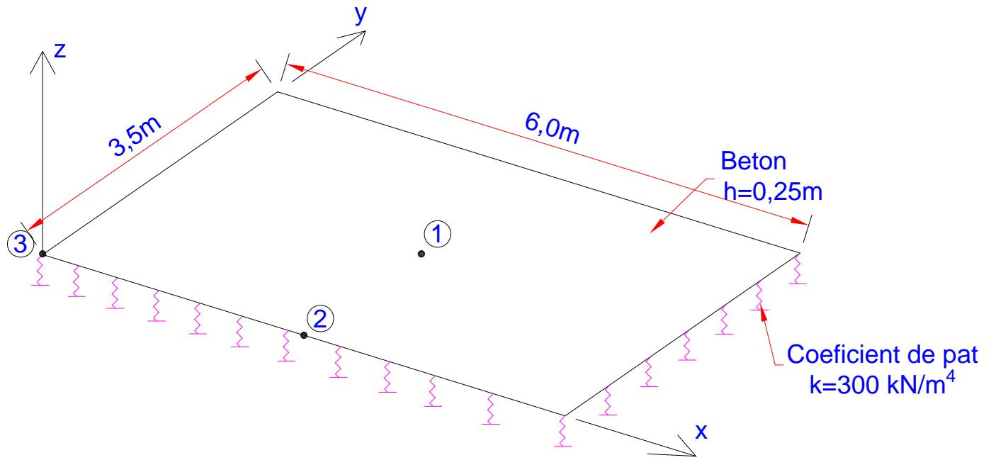
La modelarea cu elemente finite se vor utiliza elemente de forma dreptunghiulara cu noduri la colturile elementului.
